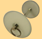
Shuttle (90% vom Rohr ID) montiert
